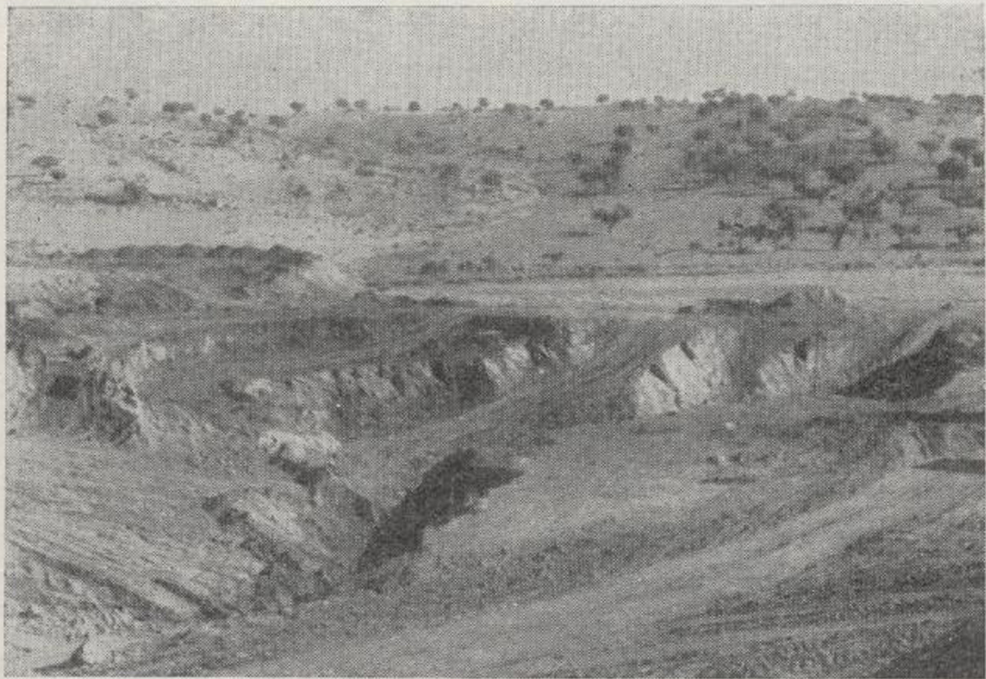
Foto 2.—La cantera de explotación. Se observan los buzamientos de la formación pizarrosa con vergencias hacia el granito, al fondo a la izquierda.
